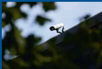
Kamera ARTR (automatycznego rozpoznawania tablic rejestracyjnych)
