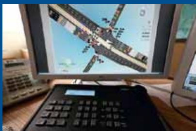
Konsola operatora podsystemu wideomonitoringu
